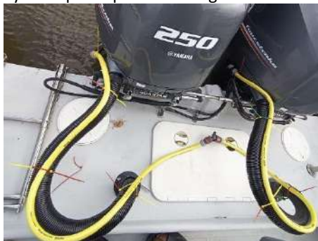
Systeme de rincage des moteurs © association Titè
