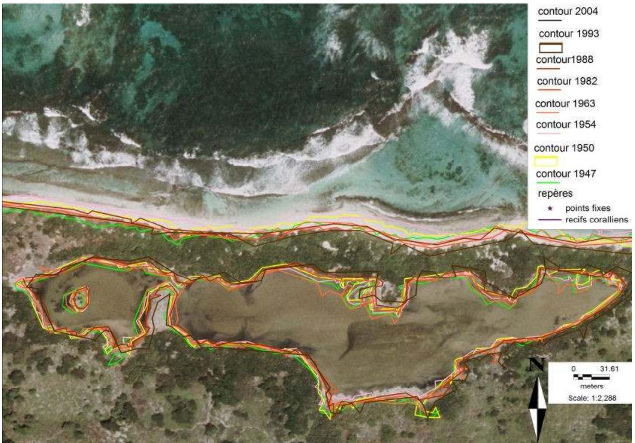
Figure 6 : Dynamique de l'érosion au niveau de la saline 2.
